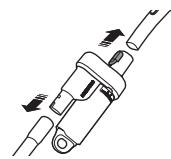
2. Поверните контейнер для пыли против часовой стрелки и снимите его.
