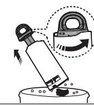
4. Очистите корпус циклонного фильтра.
