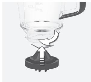
3. **Zložte kryt a nádobu.** Otočte čepelový mechanismus v směru hodinových ručiček a zložte ho. Opláchnite nože vodou a saponátom. **Varovanie! Pri manipulácii budte opatrní, nože sú veľmi ostré!** Kryt, nádobu a odmerku možno umývať v umývačke riadu.
